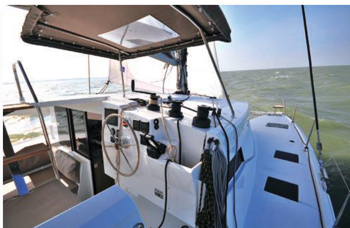
↑ Le poste de barre regroupe toutes les manœuvres ; pas trop exposé, il préserve également la silhouette. Notez le coffre de rangement pour les bouts et les sangles pour lover les drisses.
